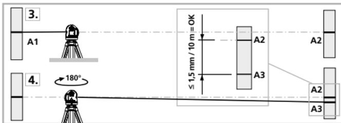
**!** Jos A2 ja A3 ovat toisistaan etäimmällä kuin 1,5 mm / 10 m, on säätö tarpeen. Ota yhteys paikalliseen laitetoimittajaan tai UMAREX-LASERLINER huolto-osastoon.
