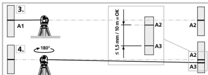
**!** Si A2 y A3 se encuentran a más de 1,5 mm / 10 m entre sí, será necesaria un ajuste. Póngase en contacto con su distribuidor especializado o diríjase al Servicio Técnico de UMAREX-LASERLINER.
