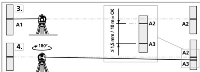
**!** Wanneer het verschil tussen punt A2 en A3 groter is dan de aangegeven tolerantie, nl. 1,5 mm / m, is een kalibratie nodig. Neem hiervoor contact op met uw vakhandelaar of met de serviceafdeling van UMAREX-LASERLINER.
