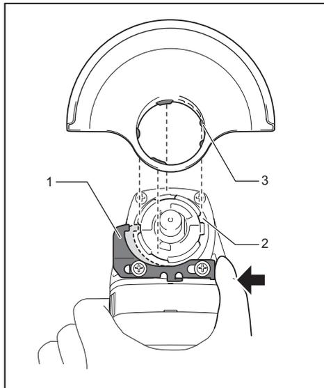
► 1. Lock lever 2. Notch 3. Protrusion
